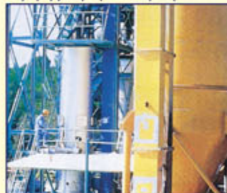
Επεξεργασία και διογκωση του περγλίτη στους 900-1000°C
